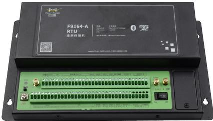
F9164-A 遥测终端机集传统遥测终端机功能与 2G/3G/4G/Ethernet /NB-IOT/LoRa 等通信功能于一体，实现水文/水资源/环保 212/TCP Modbus/MQTT 等数据的采集、存储、控制、报警及传输等综合功能。
